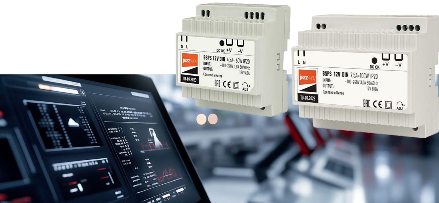
Блок питания **BSPS 12V** поставляется в пластмассовом корпусе с креплением на DIN-рейку и предназначен для преобразования входного переменного напряжения 100–240 В в постоянное стабилизированное напряжение 12 В. Имеет защиту от перегрузки, превышения выходного напряжения и короткого замыкания на выходе. Используется для питания светодиодного и промышленного оборудования.
